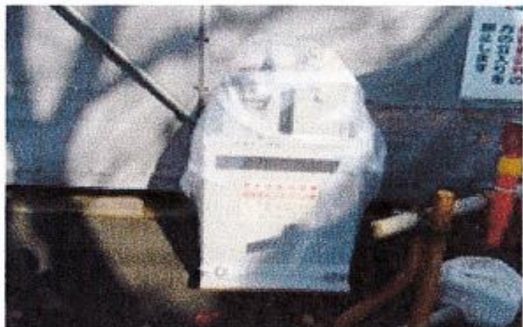
※ 可搬型モニタリングポストの設置
