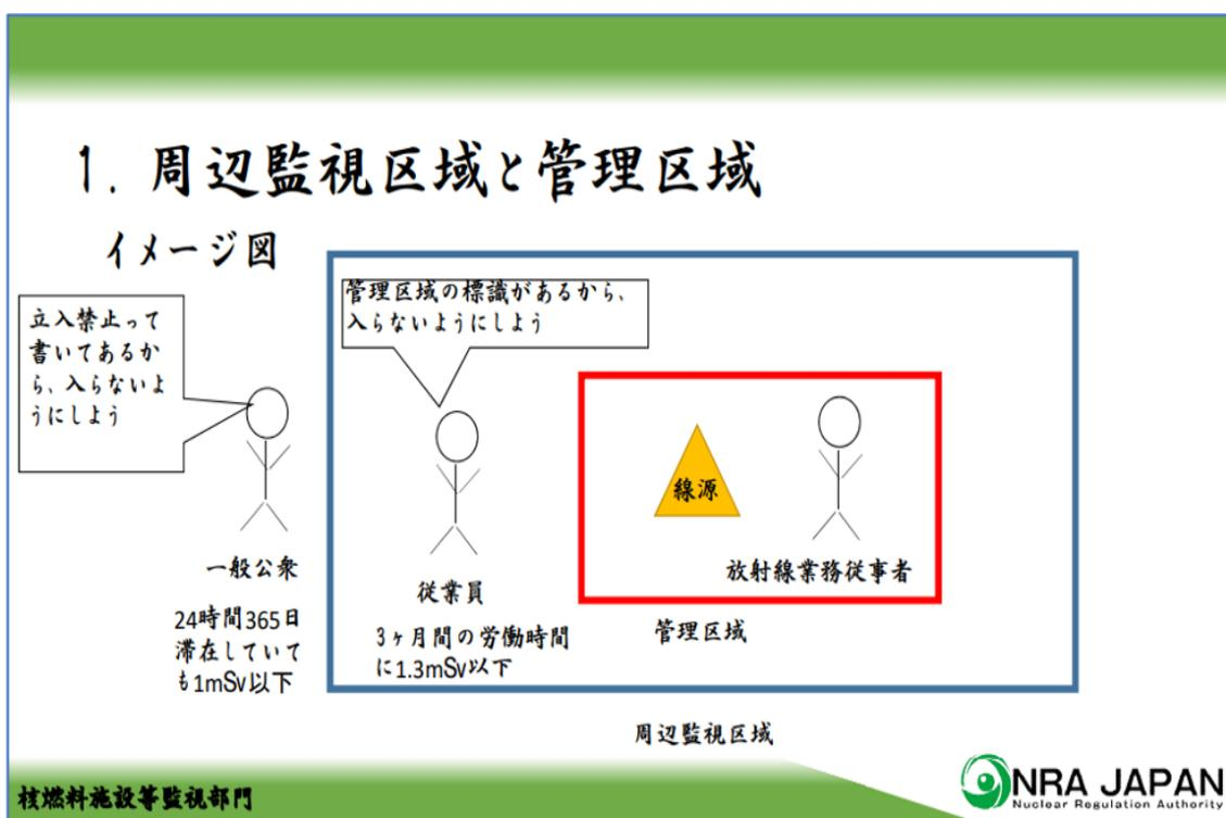
原告評価：上記は、一般公衆の線量限度と発電所周辺監視区域内との関係を図示したものである。特筆すべきは、本件事故直後から図示された区域区分が行われず、世間を騙し、被ばくの影響を否定していることである。
