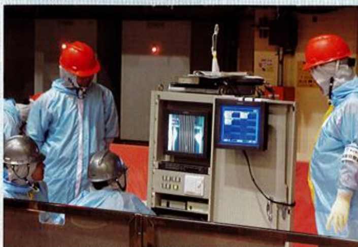
▲水中テレビカメラによるMOX燃料の点検作業の様子
