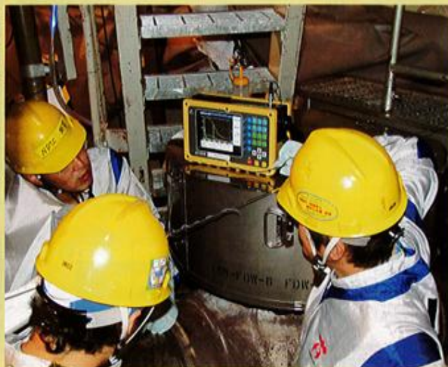
▲超音波の波形から機器の経年変化を監視します
