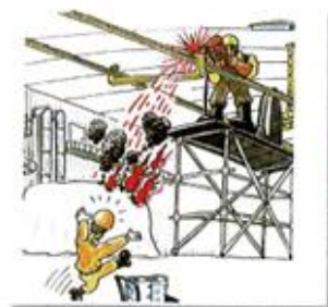
火気作業中、火花が下のシートに飛びボヤが発生
